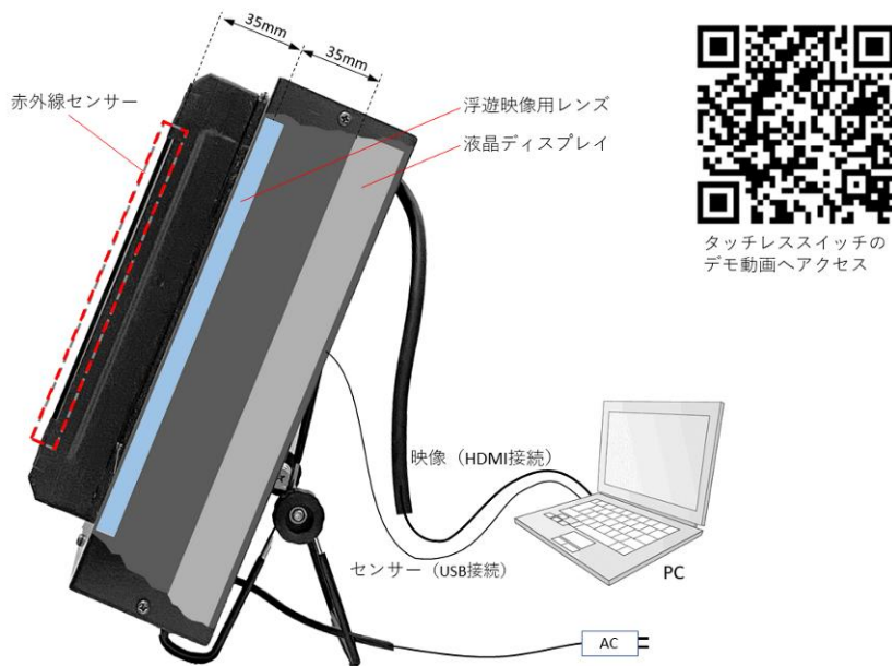
図5 タッチレススイッチの構成(QRコードはデモ動画リンク先)
