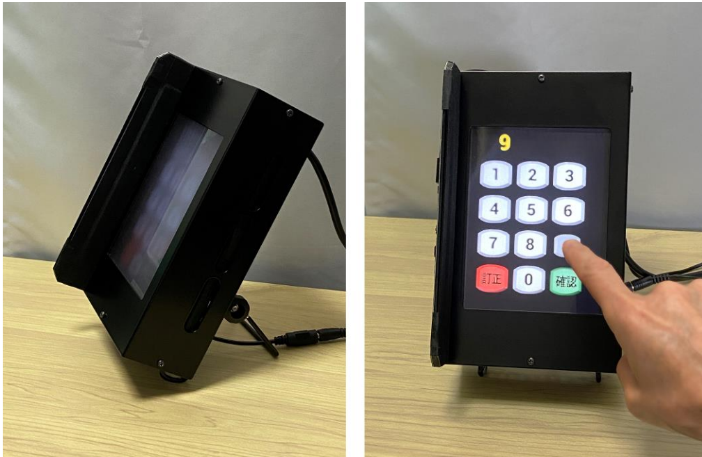
図4 タッチレススイッチ試作品(空中映像は実写)
