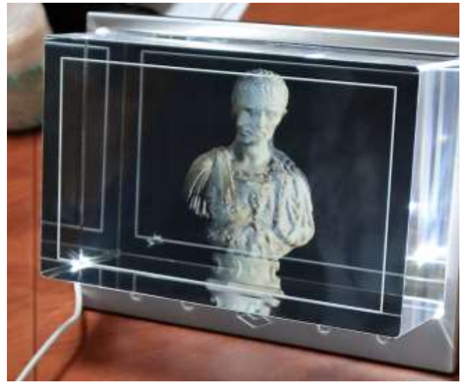
図 8 サイドローブの境界で二重像が発生
