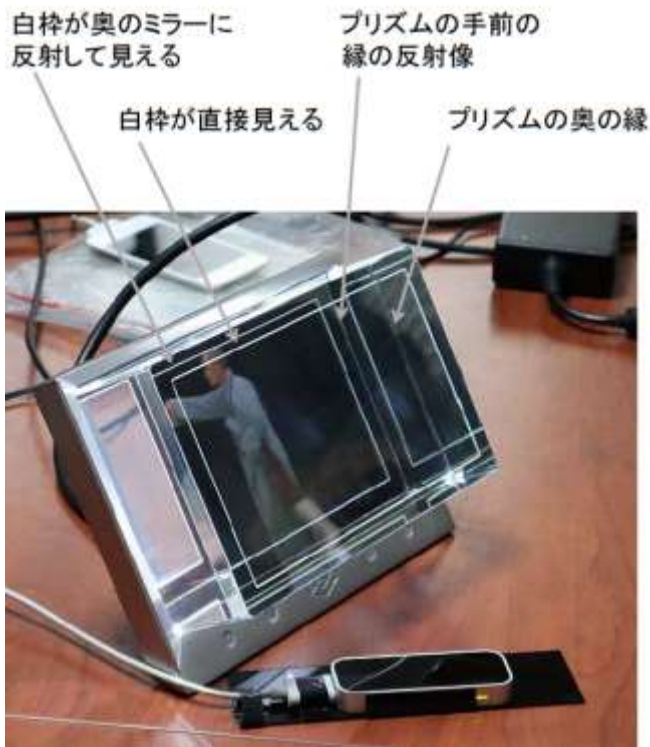
図 12 光学部品の働きの推測 (プリズム表面で光が屈折し浮き上がって見える)
