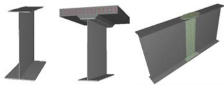
▲左：非合成I桁、中央：合成I桁、右：連結板
