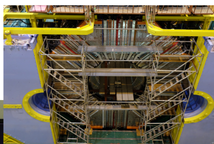
図2: 加速器 - 測定器。光速まで加速した電子と陽電子を実際に衝突させるもの。中央の穴部分に検出器をインストールして観察を行う
