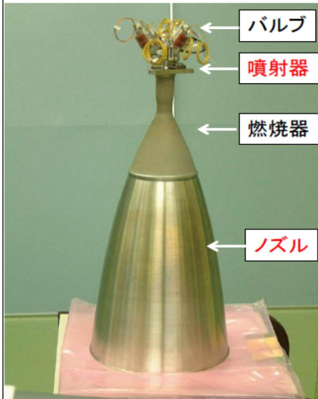
○噴射器とノズルはチタン合金製のため、EBMに適合性のあるパウダーを調達可能
